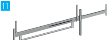
10 1323.320 Fahrbalken mit Bügel, 3,20 m, verstellbar Stahl-Rechteckrohr, feuerverzinkt. Zur Basisverbreiterung für Fahrbare Arbeitsbühnen. Breite max. 3,20 m, min. 2,30 m, Gew. 42,5 kg.
