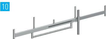
9 1214.180 Fahrbalken 1,80 m Stahl-Rechteckrohr, feuerverzinkt. Zur Basisverbreiterung für Fahrbare Arbeitsbühnen. Breite 1,80 m, Gew. 14,4 kg.
